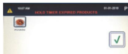
8 Lorsque le MINUTEUR DE RETENUE d'un aliment expire, les aliments expirés s'affichent. Appuyer sur la touche du CROCHET pour accepter.
